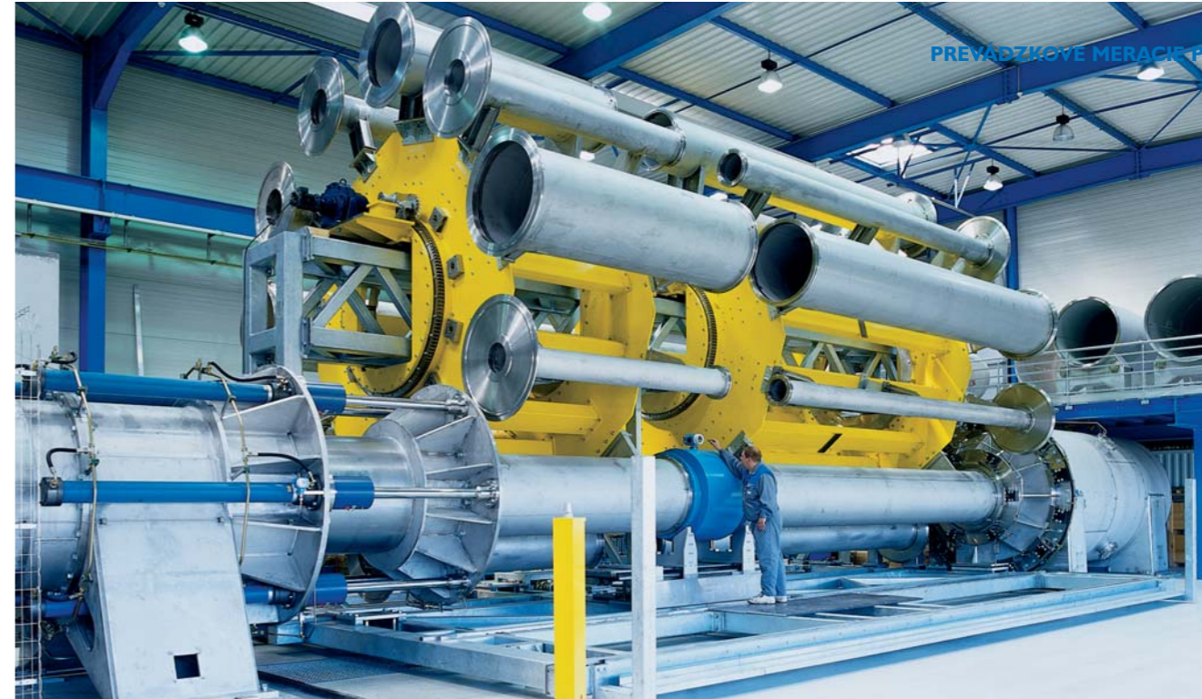
Unikátne riešenie kalibračnej stoličky s automatickým otáčacím mechanizmom, tzv. revolverom
