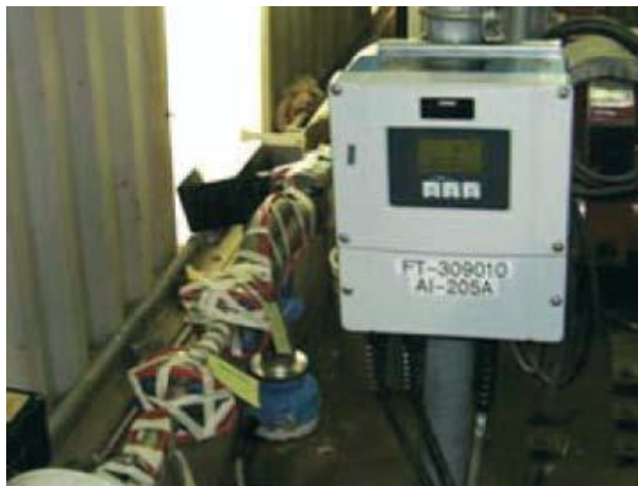
Obr. 3 Nasazení průtokoměru Promass F ve výrobě
