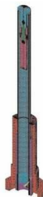
Obr. 2 Soliphant T: modelování metodou konečných prvků
