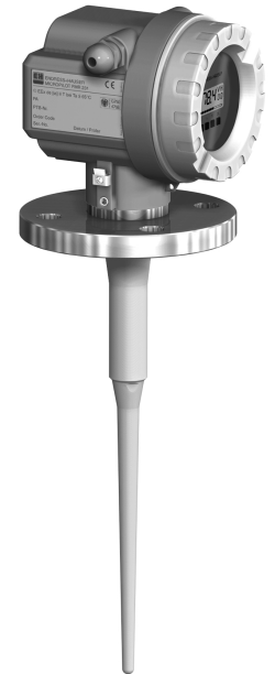
Provedení s anténou potaženou PTFE, s hlavicí F12 a přírubou DN 100.
